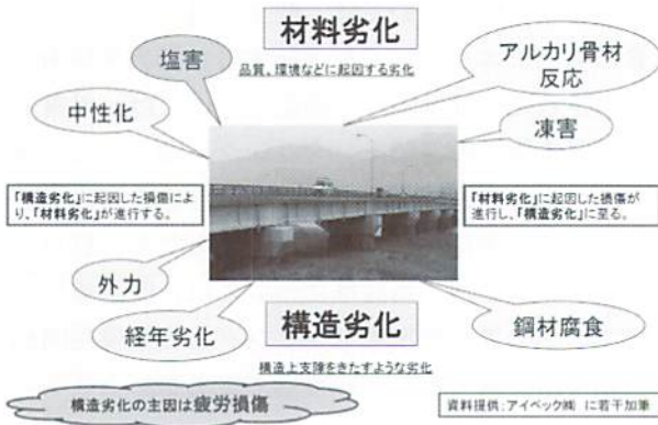
図1 構造物の劣化の要因と連鎖
